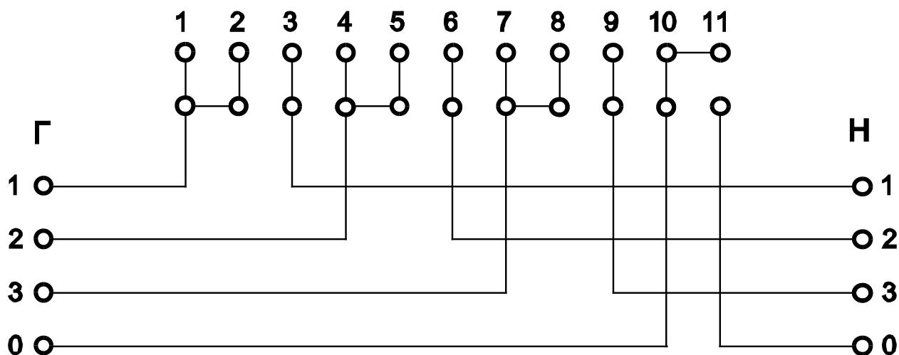
**2. Маркировка телеметрических, поверочных выходов, выходов частоты часов реального времени и интерфейса RS-485.**
